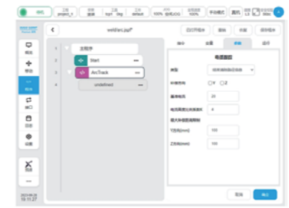
电弧跟踪 Arc Tracking
